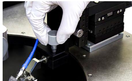
図4. TITAN™ プローブのプラナリティ調整
