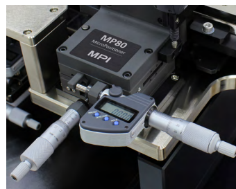
MP80-DXマイクロポジショナ。X軸のデジタル・マイクロメータ使用
