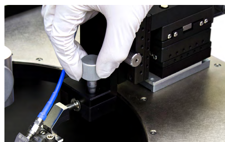
図 4. TITAN™ プローブのプラナリティ調整
